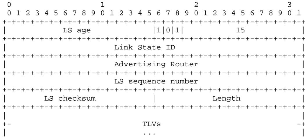
OSPFv3 Autoconfiguration (AC) LSA
